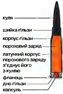
Патрон гвинтівки Набіє з металеву гільзою
